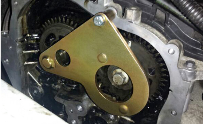
ARRETIERWERKZEUG FÜR NOCKENWELLEN 117426
