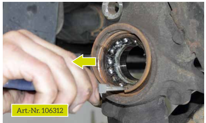
BILD 4 - ALTEN SPRENGRING ENTFERNEN
