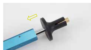
Kunststoffring zurückziehen um Kegel zu entfernen
