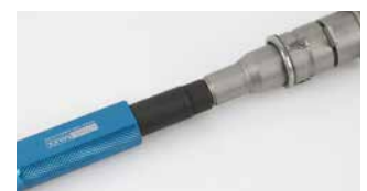
Dichtring mit Kompressionswerkzeug komprimieren
