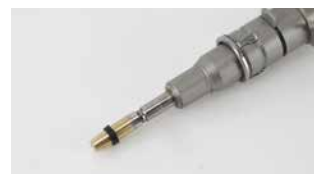
Kurzen Montagekegel und Dichtring auf Injektor setzen
