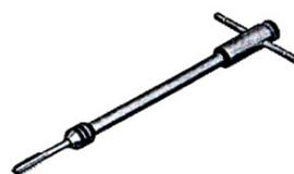
Nehmen Sie die Zentrier-/Bohreinheit Nr.9 und schrauben Sie den Bolzen Nr.12 (1/4"-28 UNF) in die Spindel und ziehen Sie mit einem 9 mm Schlüssel den Zugbolzen Nr.12 fest. Installieren Sie nun die Einheit in die Glühkerzenbohrung, ziehen Sie die Sechskantmutter M30 fest. Nehmen Sie einen 12 mm Schlüssel um den Bolzen zu befestigen. Mit einem 30 mm Schlüssel die Mutter im Uhrzeigersinn drehen, bis der Rest der Glühkerze entfernt ist.
