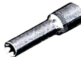
Cet outil a été mis au point spécialement pour enlever une bougie de préchauffage avec une tête défectueuse. Utilisez les autres outils du kit pour démonter le reste des bougies de préchauffage. Une nouvelle bougie de préchauffage peut être montée suivant les instructions suivantes.
