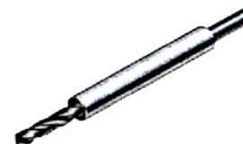
Choisissez maintenant l'outil no. 9 et placez-le dans le logement de la bougie de préchauffage. Choisissez la mèche adaptée no. 2/3 (7 x 5,5 ou 9 x 5,5) et fixez-la au moyen de no. 13 (support de perceuse). Serrez l'unité à présent montée composée de no. 2/3 et no. 13 dans une perceuse et introduire la douille de centrage no. 9 insérée auparavant (mettre en marche la perceuse). La bougie de préchauffage est percée et préparée pour les étapes suivantes.
