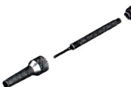
Wählen Sie den Gewindeschneider Nr.8 (M10 x P1.0 oder M8 x 1,0), setzen Sie diesen in den T-Griff ein und schneiden Sie das Glühkerze-Gewinde nach.
