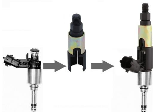
Anschließend können die neue(n) Düse(n) und alle demontierten Bauteile wieder montiert werden. Zudem sollte der Kraftstofffilter direkt mit gewechselt werden, um Verschmutzungen im System vorzubeugen.
