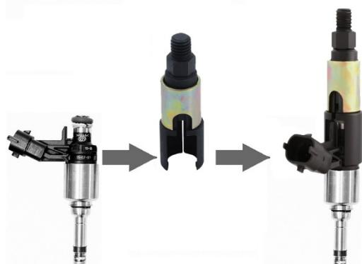
La (les) nouvelle(s) buse(s) et toutes les pièces démontées peuvent ensuite être remontées. En plus, le filtre à carburant devrait également être changé simultanément pour prévenir l'encrassement de l'installation.
