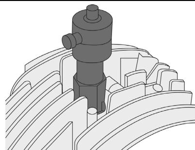
3. Desserrez la vis de fixation.
