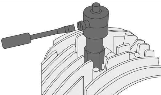
6. Kurbelwelle eine halbe Umdrehung gegen die „normale“ Drehrichtung drehen.
